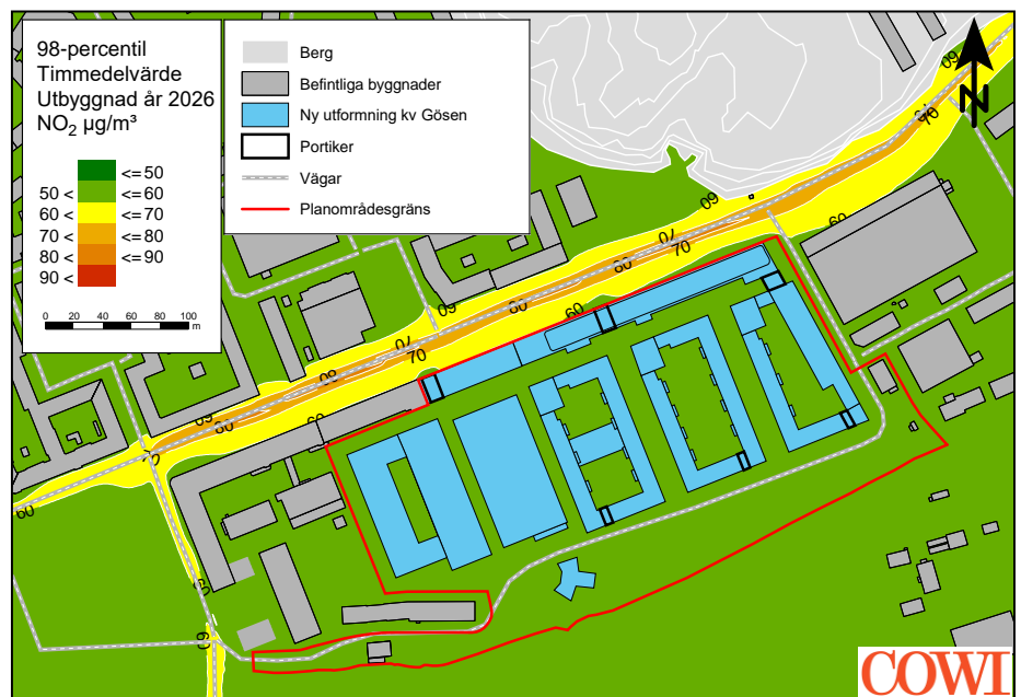
Figur 7 98-percentil timmedelvärde för NO 2 i ett a) nollalternativ och b) ett utbyggnadsalternativ. Gul färg representerar ett överskridande av miljökvalitetsmålet och röd färg representerar ett överskridande av MKN. Portiker är markerade med svarta rektanglar.
